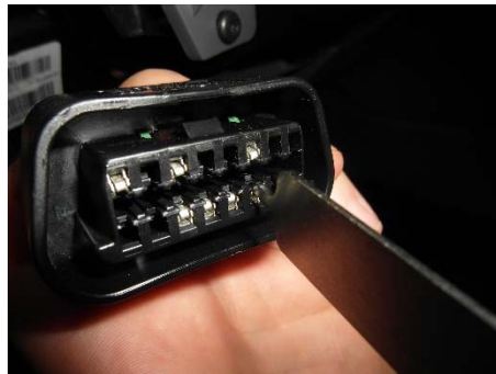
Auspinnen und in mitgelieferte Buchse wieder einpinnen
