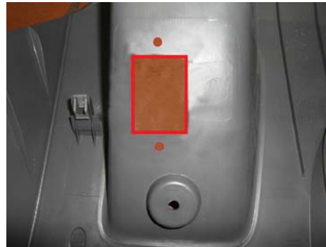
Vergrößerung der Öffnung und Bohrungen für OBD-Saver
